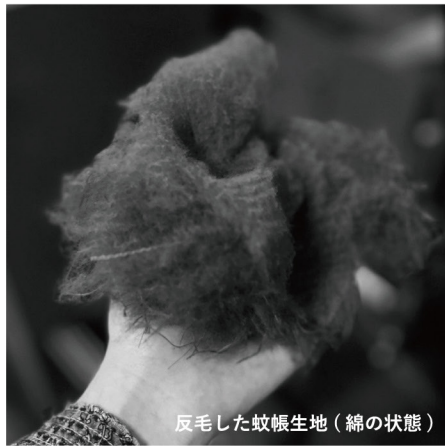
反毛機（トゲのついたローラー）で生地を掻いて綿に戻す
